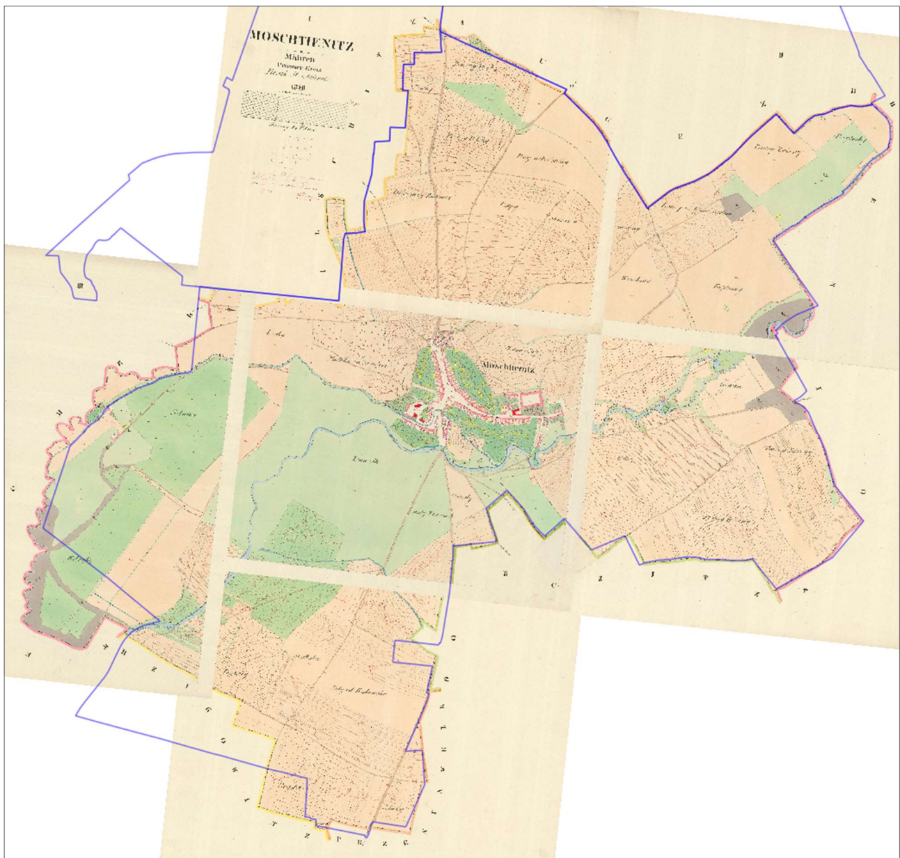
Obr. 1: Spojené a georeferencované listy map Císařských povinných otisků stabilního katastru. Modrá linie vyznačuje dnešní hranice katastru (zdroj: grafická část studie/QGIS).
