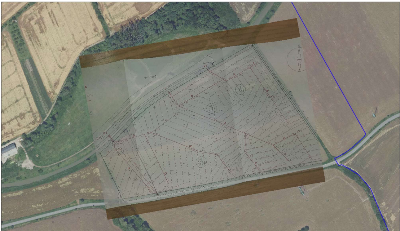
Obr. 39: výkres melioračního projektu Bařina georeferencovaný do grafické části projektu (zdroj: grafická část studie/QGIS)
